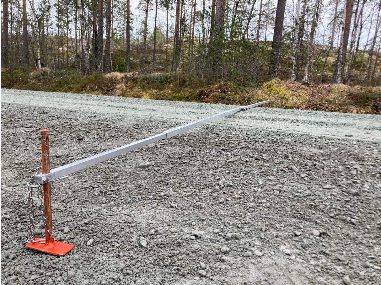
Bilde 1: utstyr for måling av tosidig tverrfall (kuv)
